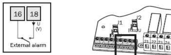
Obr.66 Příklad zapojení dig. vstupu pro externí poruchu
